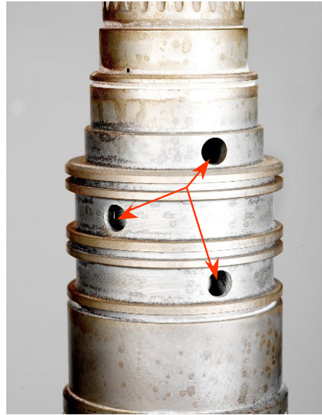
Fig. 19 a/b: esempio di analisi macroscopica su albero di trasmissione con presenza di bave da lavorazione meccanica
