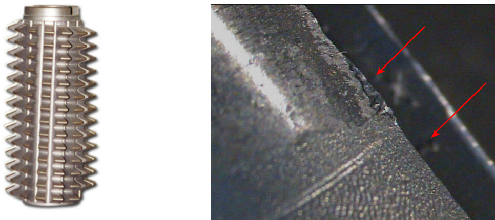
Fig 16 : utensile creatore sbavato e preparato per trattamento coating e vista microscopica del dente dopo trattamento (zona in basso senza bava), e non trattato (zona in alto con bava)
