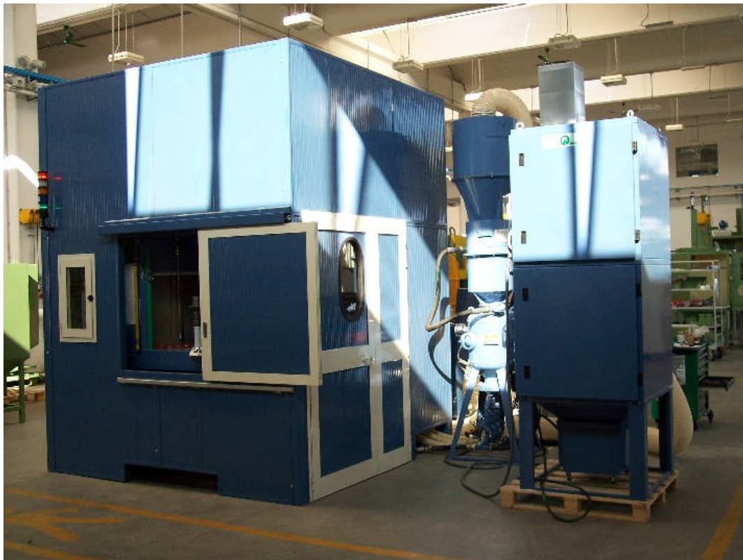
Fig. 17: Impianto di sabbatura a satelliti per la sbavatura dei fori di lubrificazione di alberi di trasmissione
