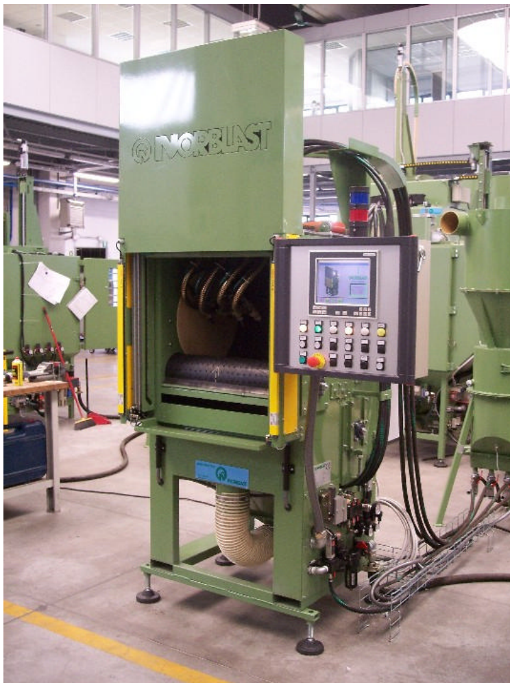
Fig. 1: Impianto di sabbiatura/pallinatura a tappeto
