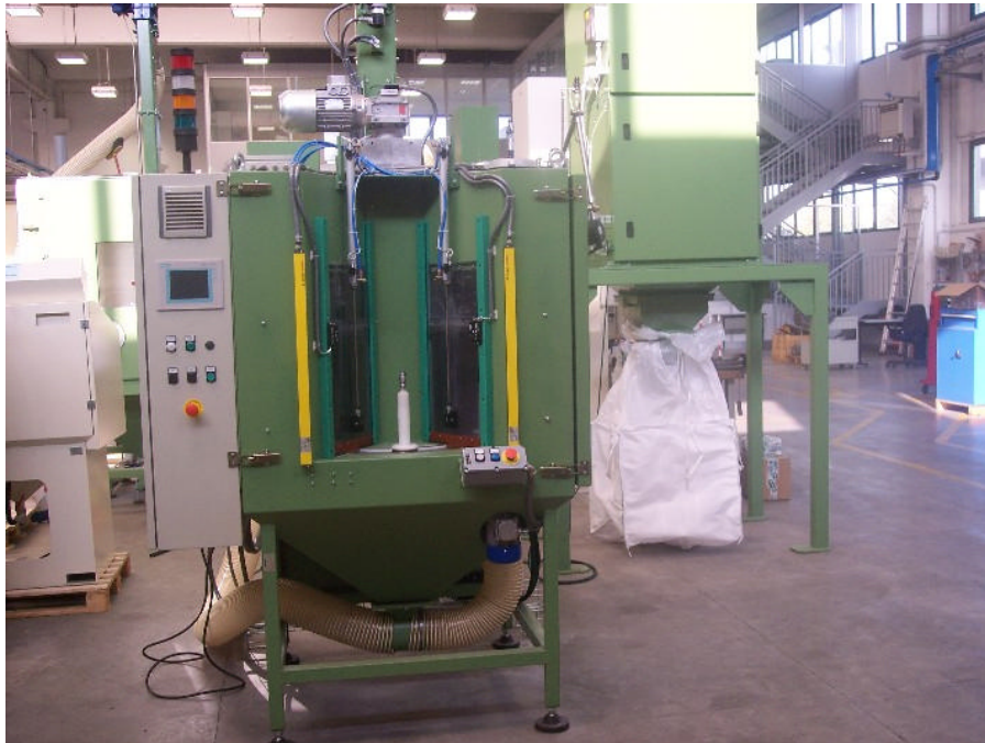
Fig 10: Impianto di sabbiatura/pallinatura a satelliti con caricamento pezzi in tempo mascherato
