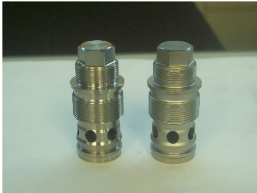
Fig 13: distributori oleodinamici sbavati con impianto a satelliti
