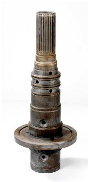
Fig. 18 a/b: albero di trasmissione trattato e relativa zona di carico e scarico pezzo in tempo mascherato
