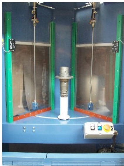
Fig. 18 a/b: albero di trasmissione trattato e relativa zona di carico e scarico pezzo in tempo mascherato
