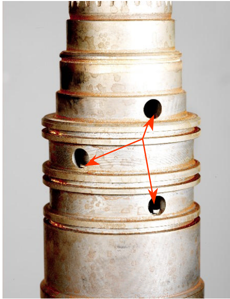
Fig. 19 a/b: esempio di analisi macroscopica su albero di trasmissione con presenza di bave da lavorazione meccanica
