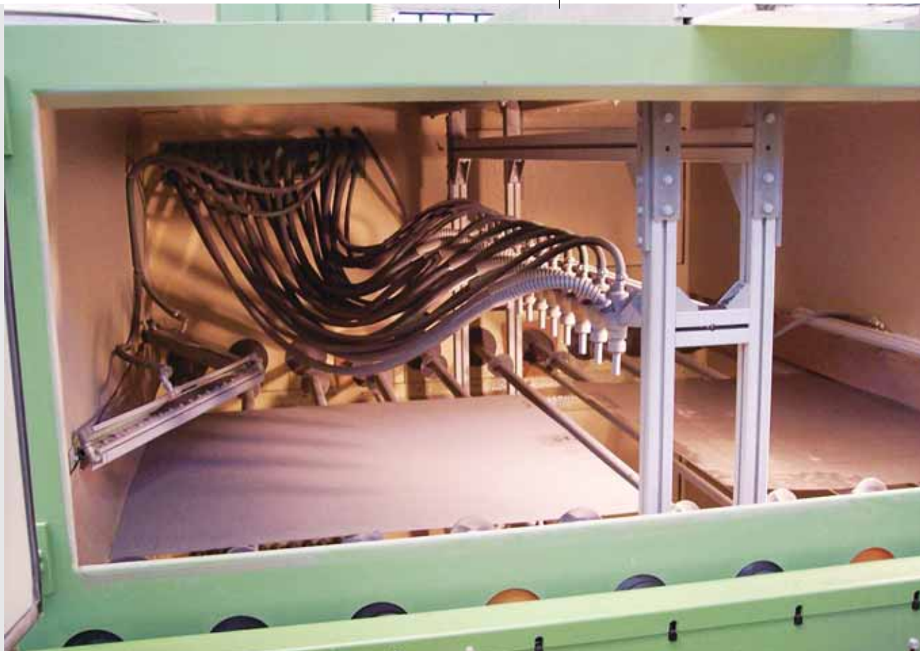
6. Dettaglio della cabina e del gruppo sparo.
