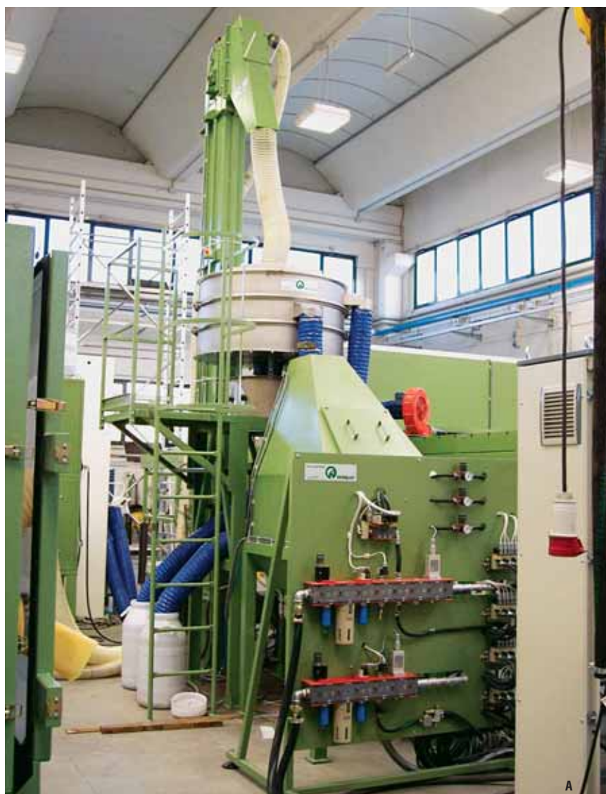
8. Dettagli di impianto: a) sistema di ricircolo graniglia; b) display sistema di controllo.
