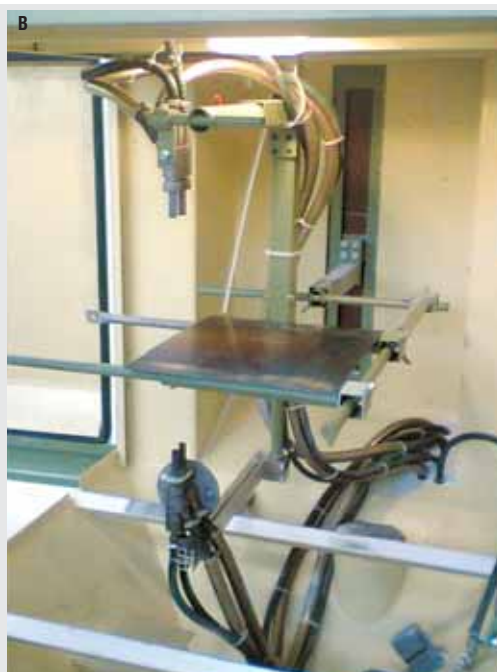
4. Prove di incurvatura: a) singola; b) doppia fila di pistole.
