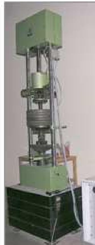
Fig. 12 – Schema della provetta di flessione a 3 punti e dell'apparecchiatura di prova.
